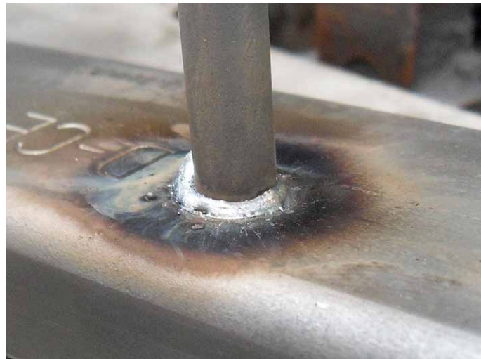
Bild 3: Ohne Schweißbadschutz geschweißt, Durchmesser 10 mm. Der Aluminiumzusatz an der Spitze verbessert das Ergebnis deutlich. (© Trillmich)
