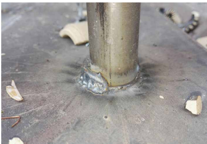
Bild 1: Schweißwulst nicht geschlossen (© Trillmich)
