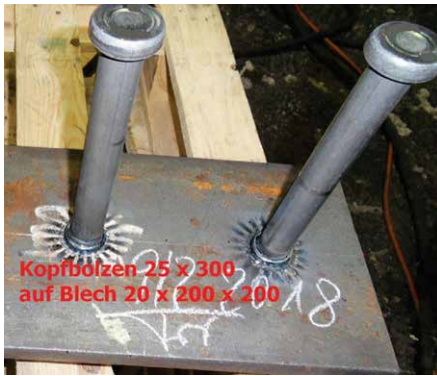
Bild 8: Einwandfreies Ergebnis bei kleiner Ankerplatte (© Trillmich)
