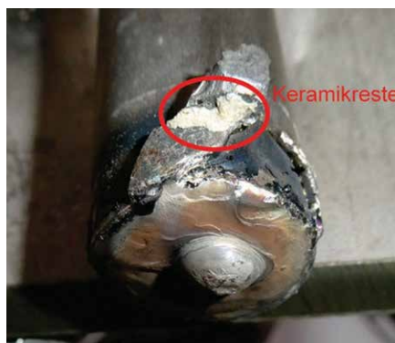
Bild 6: Spritzer aufgrund von Blaswirkung verhindern das Eintauchen. (© Trillmich)
