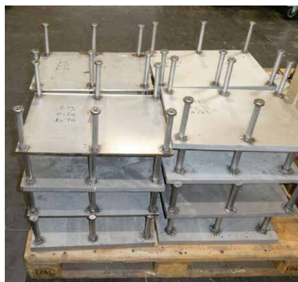
Bild 12: Nichtrostende Ankerplatten für den Nuklearbereich (© Trillmich)
