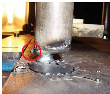
Bild 5: Schiefe Anschmelzung mit Eintauchbehinderung (© Trillmich)
