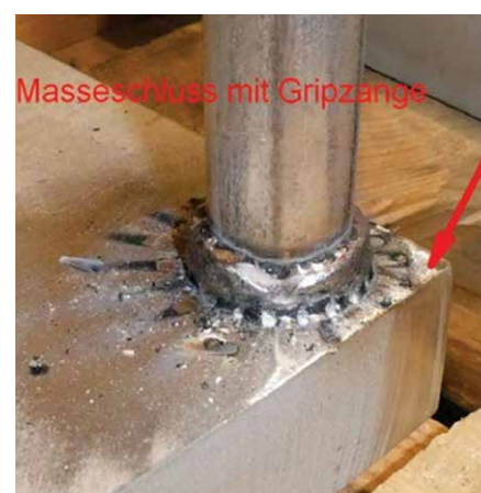
Bild 15: Einwandfreies Ergebnis sehr nahe an der Plattenecke (© Trillmich)
