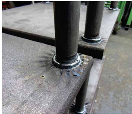
Bild 9: Einwandfreies Ergebnis auch in der Plattenecke (© Trillmich)
