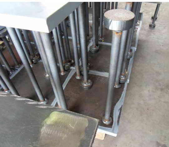
Bild 1: Ankerbolzen, hergestellt aus Einzelteilen und manuell aufgeschweißt (© Trillmich)
