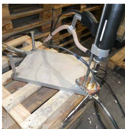
Bild 14: Erfolgreiche Kompensation nur mit zwei Masseklemmen (© Trillmich)
