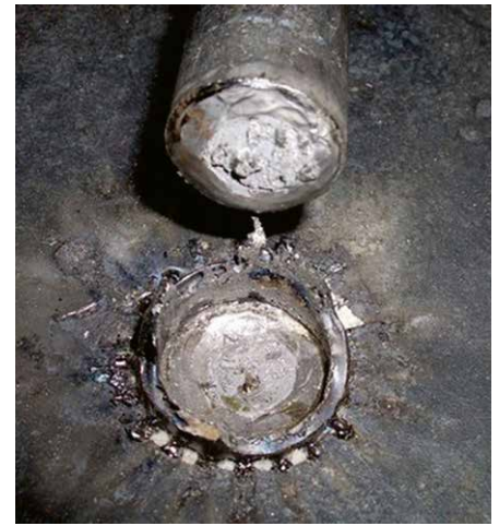
Bild 17: Versagen bei der Biegeprüfung trotz bestandener Sichtprüfung (© Trillmich)
